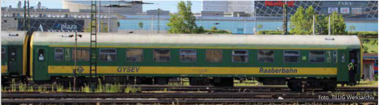
Reisezugwagen 1. Klasse Ap, Typ Y/B 70, der GySEV 1st class passenger coach Ap, typ Y/B 70, of the GySEV
